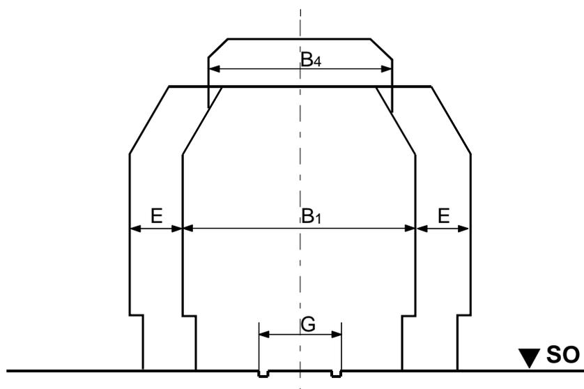
Für die Erweiterung ist der seitliche Ausschlag der Fahrzeuge bestimmend. Den größten seitlichen Ausschlag weisen Drehgestellwagen zur Bogen-Innenseite hin auf. Die Länge des jeweils eingesetzten Drehgestellwagens ist somit ausschlaggebend für die Größe des Maßes  $E$ .
